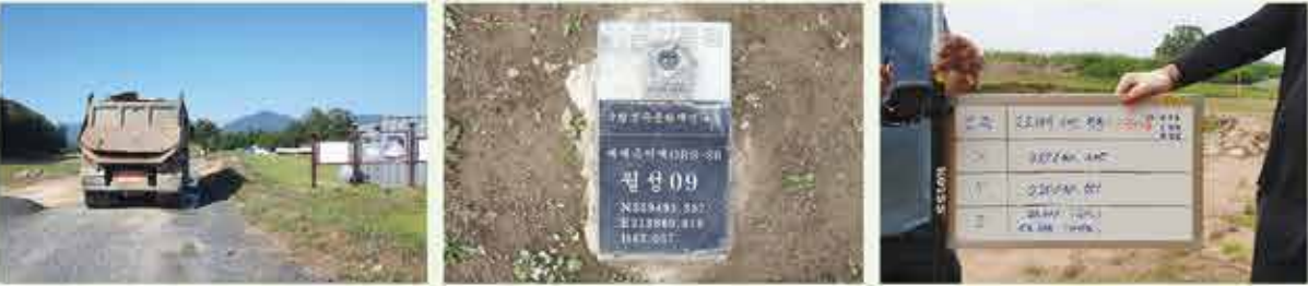
석빙고 외부 진동계 설치 석빙고 내부 진동계 설치 월성사면 신축계 설치
