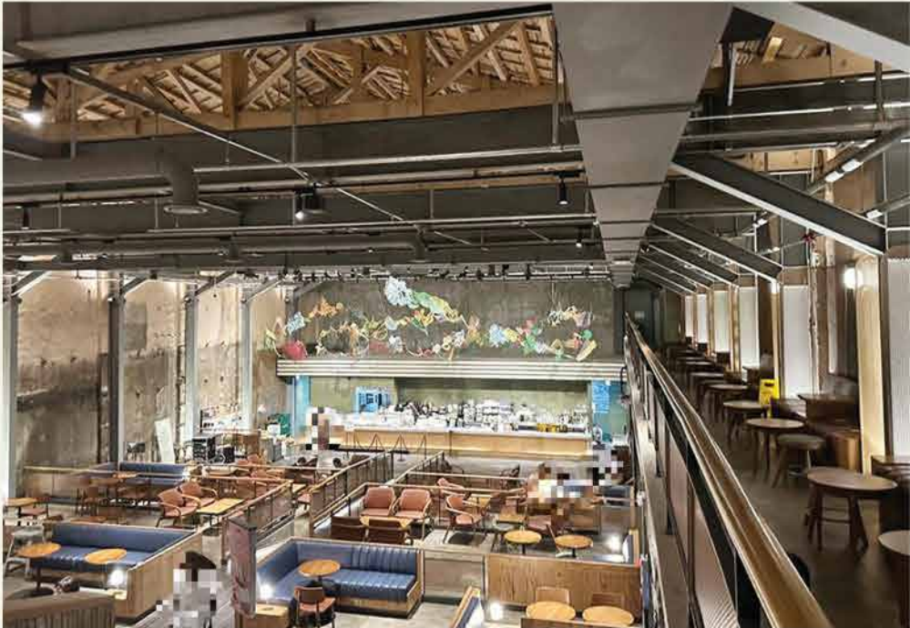
9. <스타벅스 경동 1960점>, 영사실 쪽에서 극장 스크린 쪽을 향해..... 스타벅스 카운터이다. 객석은 경사를 잘 살려 부스 형태로 그렘했다. 오른쪽은 통로인데 독립 좌석이다. 천정은 목조 트러스에 목재 상판 붙임이다. 대들보와 현치는 구조재로 보강한 것이다.
